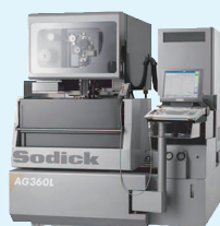
短納期を可能にする ワイヤーカット放電加工機
